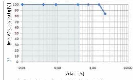
Durchschnittliche Regenspende in Deutschland zu 80% unter 15 l/(sxha), das ergibt einen Volumenstrom von 0,32 l/s bei einer Dachfläche von 213 m<sup>2</sup>.
