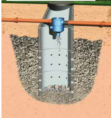
Anwendungsbeispiel 2: Einbau in einem Sickerschacht
