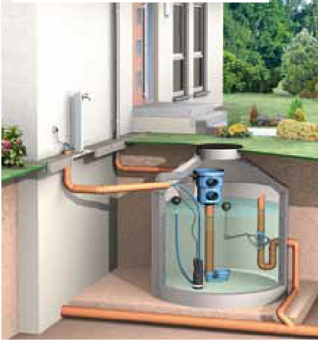
Anwendungsbeispiel 1: Einbau direkt in den Regenspeicher aus Kunststoff mit Retentionsdrossel
