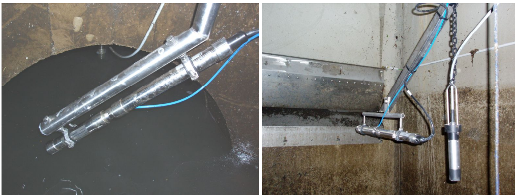
Bild 6 Photometersonde in Zulauf (links) und Ablauf des RKB (rechts)
